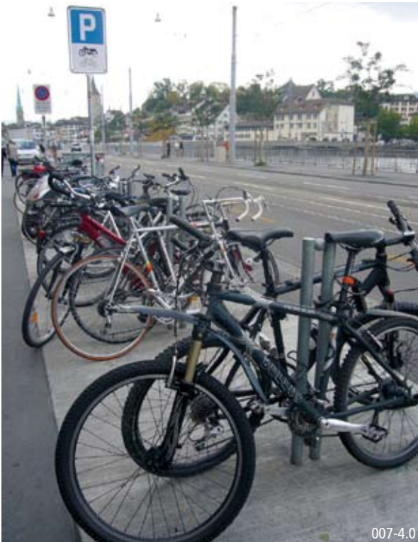
Impianto aperto e non coperto, con archetti, collocato nello spazio pubblico
